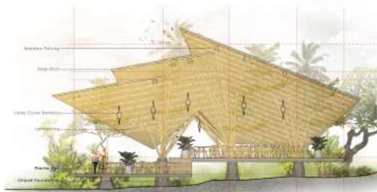
Gambar 2. Bentuk Panggung sebagai Respons Panas Tanah/Pasir Pantai Sumber: hasil analisis, 2021
